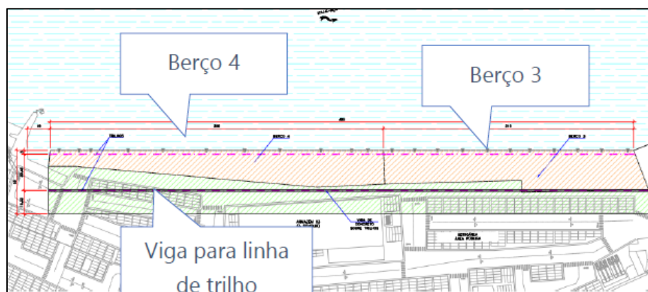
Figura 23 – Localização da viga para linha de trilho STS
